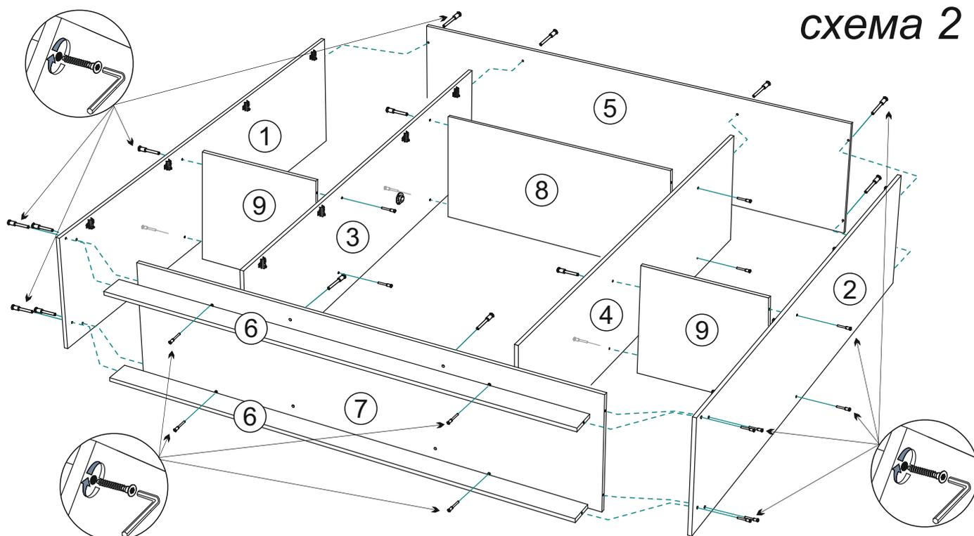
4. Чтобы установить задние стенки (детали №15, №16), необходимо сбранную конструкцию перевернуть лицевой стороной вниз. Замерить, с помощью рулетки, и уровнять диагонали ( $a=b$ ). Наложить задние стенки предварительно соединив №16 брусом для ЛДВП №18 и аккуратно, не нарушая диагоналей, прибить ЛДВП гвоздями, с шагом 130-150 мм, затем также гвоздями прибейте подпятники на боковины и цоколя, (схема 3).
